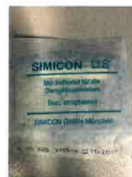
Fig. 4: Bio indicator acc. DIN 58949-4
